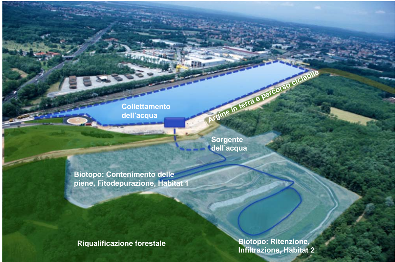
Fig. 6. Schema di funzionamento dell'area d'intervento (Gallarate, Va). I bacini raccolgono l'acqua di seconda pioggia dello scalo intermodale (area azzurra nell'immagine) più quella di un altro scalo di pari superficie. Ciò consente di alleggerire notevolmente la rete fognaria e di conservare la qualità dell'acqua che, invece di mischiarsi ai reflui, viene fitodepurata nel primo bacino e infiltrata nel secondo. Totale superficie impermeabile = 350.000 m 2 ; Capacità totale dei 2 invasi : 250.000 m 3 .
