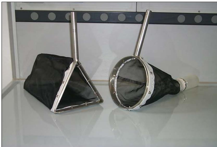
Fig. 1. Attrezzature di campo per il campionamento di sorgenti: retino triangolare da benthos per la raccolta diretta (a sinistra) e retino da drift, dotato di un collettore terminale svitabile (a destra).
