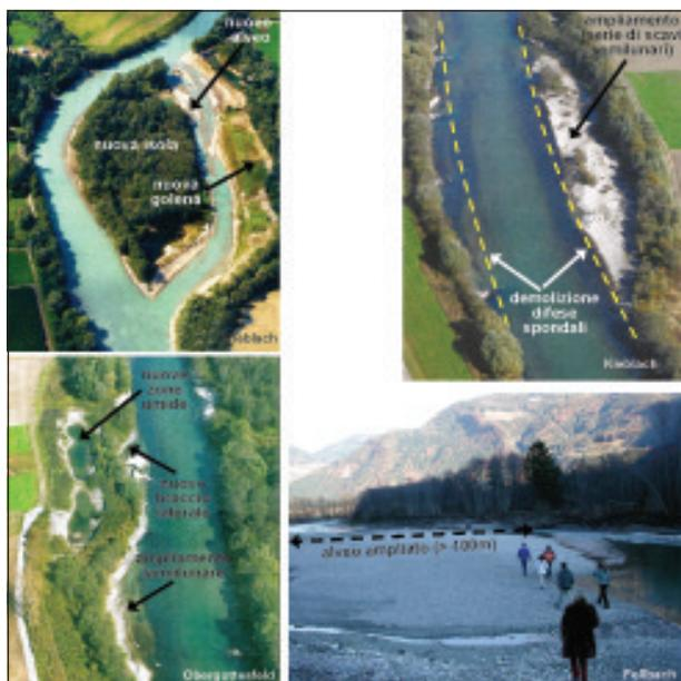
**Fig. 14.** Esempi di interventi attuati sulla Drava austriaca per contrastare l'incisione dell'alveo: demolizione delle difese spondali in massi e scavo di: lembi semilunari di nuova piana inondabile, alvei secondari (con formazione di isole fluviali), bracci laterali e zone umide perfluviali.
