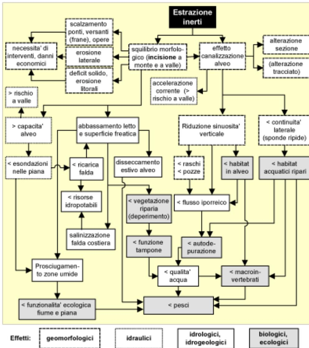
Fig. 6. Schema degli effetti geomorfologici, idraulici, idrologici, idrogeologici, biologici ed ecologici dell'estrazione di inerti. L'incisione indotta da escavazioni localizzate si ridistribuisce sia a monte che a valle; gli impatti illustrati interessano perciò gradualmente l'intero reticolo idrografico (da CIRF, 2006).
