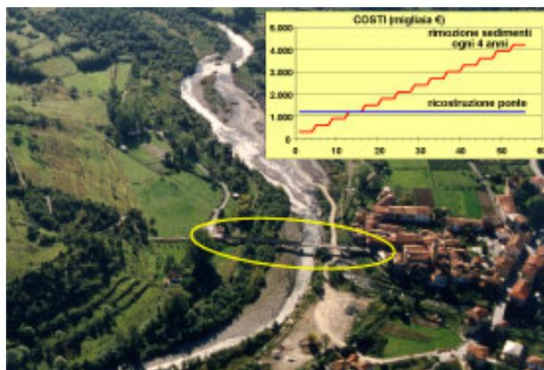
**Fig. 11.** Tradizionalmente, nel caso di luce insufficiente di un ponte (nell'ovale), si asportano sedimenti. Il costo dell'intervento, ripetuto negli anni, a lungo termine supera quello della ricostruzione del ponte con arcate più alte e meno piloni in alveo.
