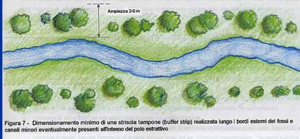
Figura 7 - Dimensionamento minimo di una striscia tampone (buffer strip) realizzata lungo i bordi esterni dei fossi e canali minori eventualmente presenti all'interno del polo estrattivo
