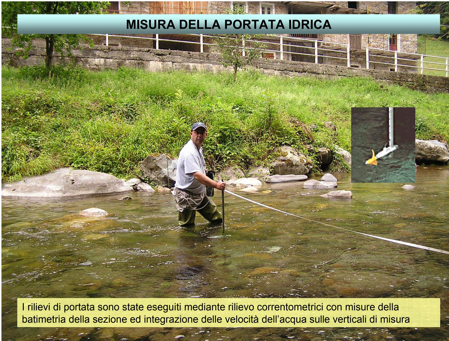
I rilievi di portata sono state eseguiti mediante rilievo correntometrici con misure della batimetria della sezione ed integrazione delle velocità dell'acqua sulle verticali di misura
